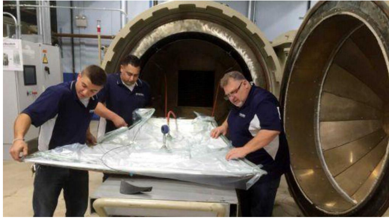
Őekil 8.1: Vakum torbasına sarılmıř kalıp i erisindeki kompozit malzemenin otoklavdan  ıkarılırken.
