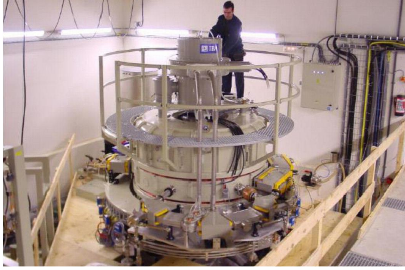
Şekil 8.2: 7.0 MeV, 700 kW X ışını jenerasyonu için kullanılan elektron hızlandırıcısı.
