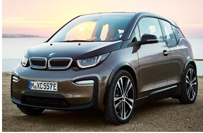
Şekil 3.3: Gövdesi karbon fiber kompozitten yapılmış BMWi3 serisi.
