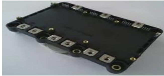
Şekil 5.10: IGBT Modülü (İzole edilmiş kapılı iki kutuplu transistör) [27].
