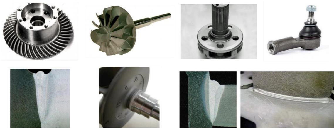
Şekil 3.4: Farklı otomobil parçaları ve elektron demetiyle kaynak yapıldığı bölgelerin görüntüsü.
