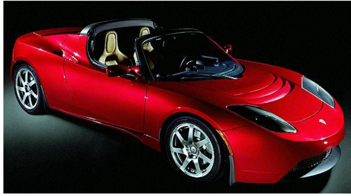
Şekil 3.4: Tüm gövdesi kompozitten yapılmış Tesla Motors tarafından geliştirilen elektrikli otomobil.
